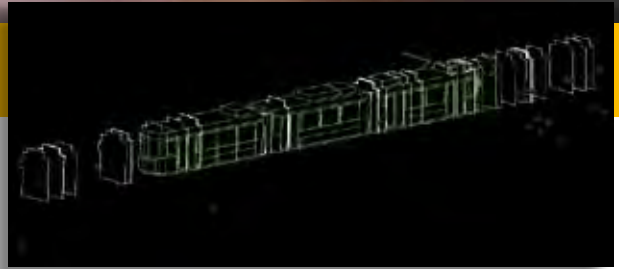
Untersuchung lage- und höhenmäßig bekannter Mess-/Zwangspunkte auf ihren räumlichen Abstand zum Hüllschlauch bzw. zu Hüllschlauchquerschnitten.
