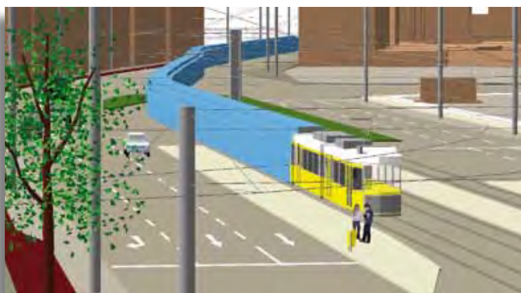
Ein Fahrzeug vom Typ GT6N und der von ihm erzeugte 3D-Hüllschlauch.
