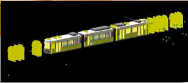
Untersuchung lage- und höhenmäßig bekannter Mess-/Zwangspunkte auf ihren räumlichen Abstand zum Hüllschlauch bzw. zu Hüllschlauchquerschnitten.
