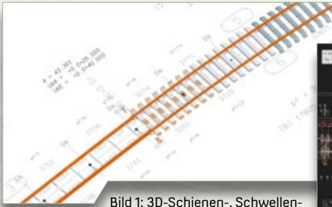
Bild 1: 3D-Schienen-, Schwellen- und Spurstangenteilung.
