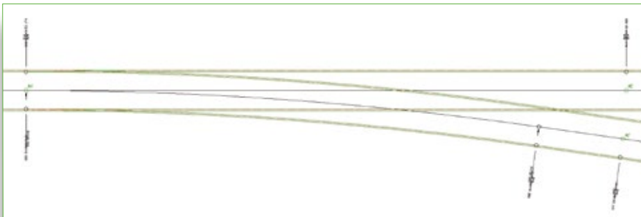
Bild 1: Im ersten Schritt werden Spur, Außenschiene und Faser generiert.
