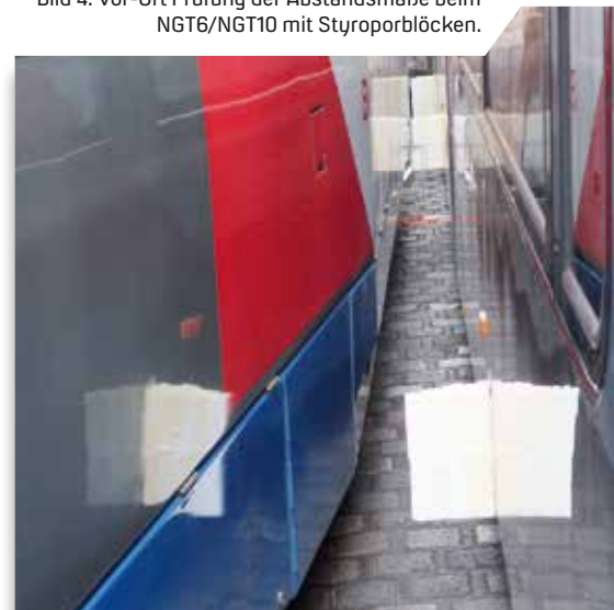
Bild 4: Vor-Ort Prüfung der Abstandsmaße beim NGT6/NGT10 mit Styroporblöcken.
