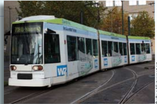
NF6-Straßenbahnwagen in Düsseldorf mit jeweils zwei einzeln angetriebenen Achsen mit nachlaufend/vorlaufend gelenktem Radpaar.
