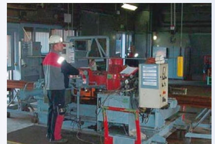
Mitarbeiter an der Biegemaschine der TSTG Schienen Technik in Duisburg.
