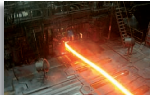
Aus einem auf 1.200°C aufgeheizten Stranggussvorblock wird innerhalb weniger Minuten das fertige Schienenprofil mit einer Länge von 120 m gewalzt.
